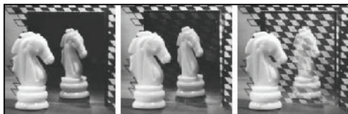
Figuur 1 – Optische transmissie van een yttrium film in de reflecterende metaalfase (links), na 1 minuut blootstelling aan waterstofgas (midden) en in een equilibrium in de transparante trihydridefase (rechts).
