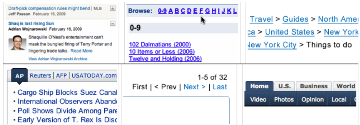
Figuur 4. Een aantal voorbeelden van verschillende manieren van navigatie op een website. Van links naar rechts en van boven naar beneden: Accordion, Alphanumeric Filter Links, Breadcrumbs, Navigation Bar, Pagination en Tabs [8].
